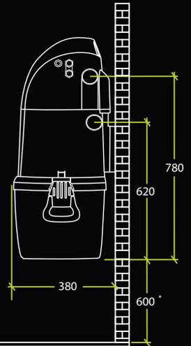
\* Distance minimum recommandée du sol pour faciliter la vidange de la cuve
